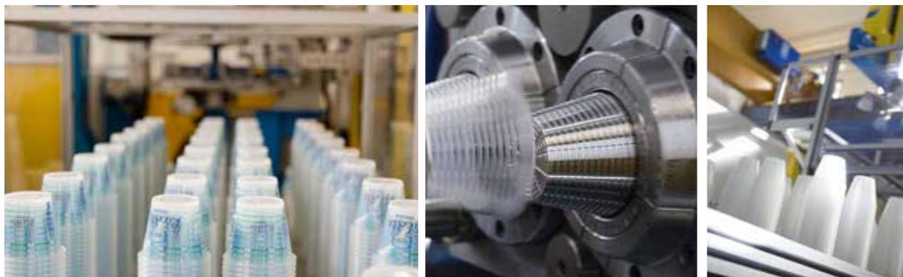
Il parco macchine è costituito da impianti di stampaggio a iniezione di ultima generazione; le presse, hanno una forza di chiusura da 30 a 850 tonnellate e sono completamente elettriche e robotizzate.
