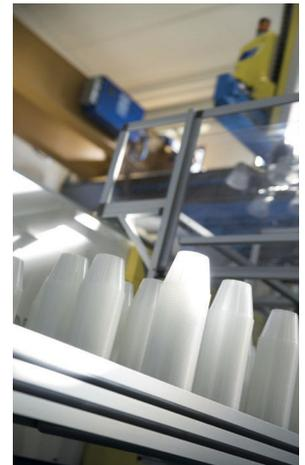
Il parco macchine è costituito da impianti di stampaggio a iniezione di ultima generazione; le presse, hanno una forza di chiusura da 30 a 850 tonnellate e sono completamente elettriche e robotizzate. La totale automazione del processo produttivo permette di realizzare uno stampaggio ultrapreciso con un ottimo rapporto qualità/prezzo e garantisce una maggiore igiene dovuta alla minima manipolazione del prodotto.
